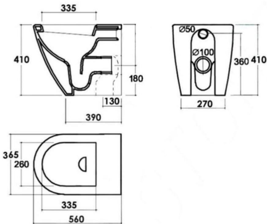
Le misure del WC Vortex, con scarico a pavimento sono L36,5 x P56 x A41 cm
